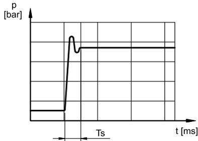
Curve di risposta dinamica ottenute commutando con una elettrovalvola direzionale la chiusura della linea di mandata della pompa.
