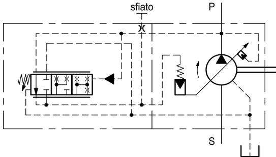
Il regolatore di pressione PC permette di mantenere costante nel circuito la pressione impostata, adeguando automaticamente la portata erogata dalla pompa alle effettive richieste delle utenze.
